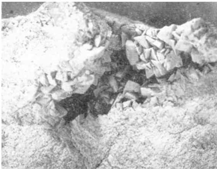
Рис. 3. Известняк с полостью пещеристого типа, почти полностью выполненной кристаллами вторичного кальцита. Дороховское месторождение, скважина 1, глубина 2103,7—2110,3 м, слой 1, образец 16, фаменский ярус. Увеличение \times 5
